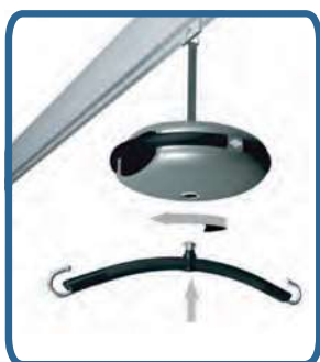
Wieszak z mocowaniem bagnetowym na Lunie. Sprężynowy mechanizm zatraskowy. W celu zamontowania i zdemontowania: wcisnąć, przekręcić, zwolnić
